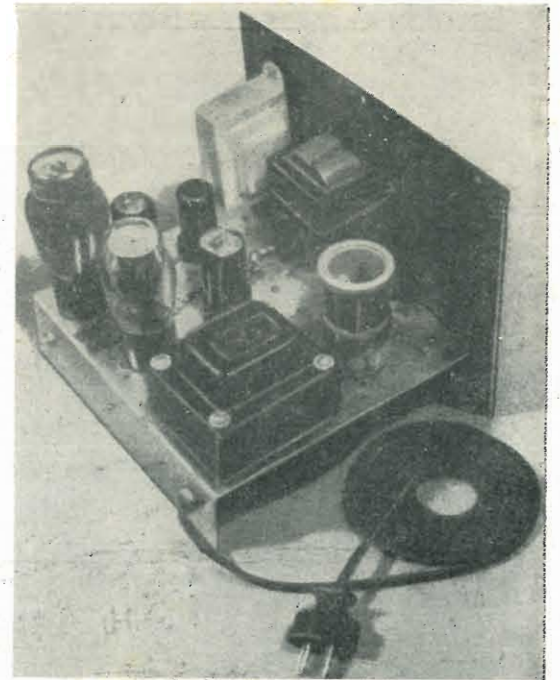
Il trasmettitore per le comunicazioni ad onde convogliate; notare la disposizione delle varie parti, e specialmente del trasformatore di alimentazione, della impedenza di modulazione, di quella del filtro, e nell'angolo in basso a destra, della bobina dello stadio di potenza a radiofrequenza, L3. Notare, poi, al centro dell'avvolgimento di essa, le sei spire del secondario, da cui la radiofrequenza è prelevata per essere immessa nella linea di illuminazione.
