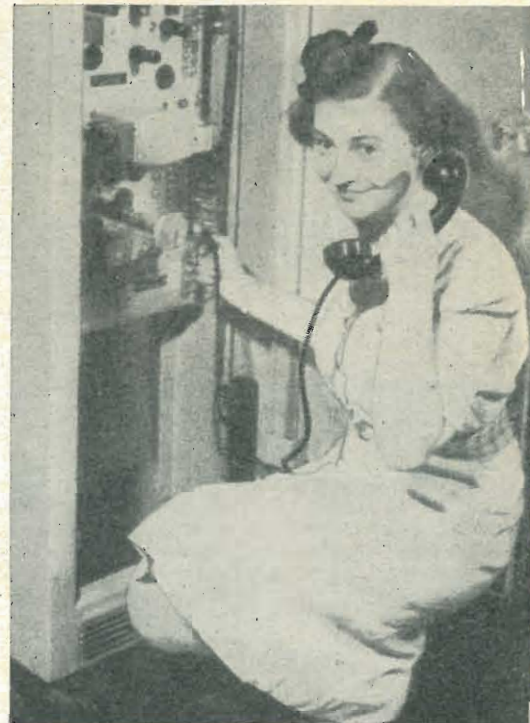
Il trasmettitore ed il ricevitore fanno capo ad un microtelefono, ed in questa disposizione, la comunicazione è altrettanto agevole come se si trattasse di un comune telefono. In questa foto è illustrata una realizzazione molto compatta e nel tempo stesso abbastanza estetica; che si raccomanda a coloro che non abbiano a disposizione molto spazio.
